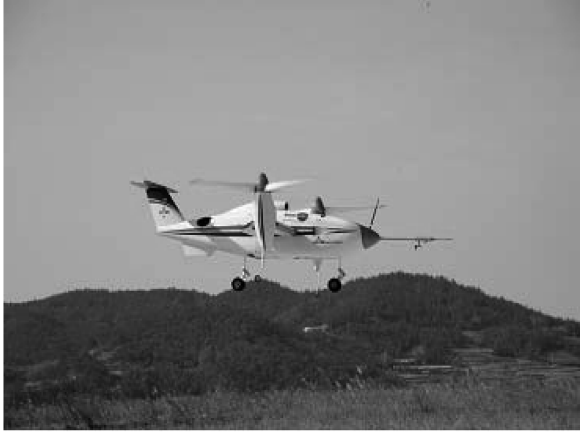
Fig. 1 A 2-m-span tiltrotor UAV in hover.
